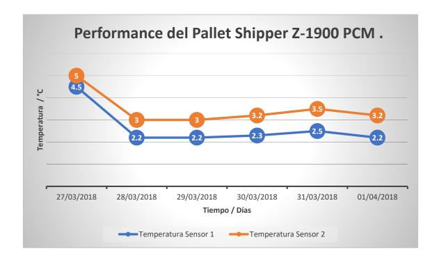
En este grafico se demuestra la estabilidad de la temperatura dentro del Pallet Shipper Z-1900 PCM. Si bien la exportación duró en total 120 horas, se demuestra que el pallet Shipper estaba en condiciones de mantener la temperatura dentro del rango de 2 C º a 8 C º durante varios días más.
